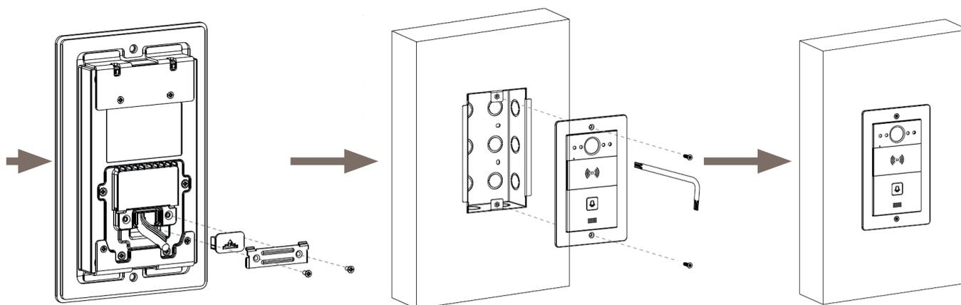
Choisissez un bouchon en caoutchouc de taille appropriée pour pousser tous les câbles dans le couvercle. Fixez la plaque de verrouillage des câbles au couvercle arrière à l'aide de deux vis M2,5x6.
