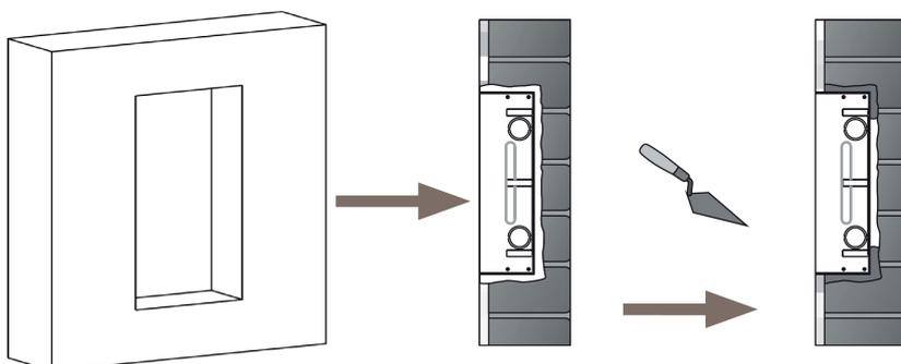
Snijd een rechthoekig gat in de muur met afmetingen 180x101x50. Het gat moet een beetje te groot zijn om alle noodzakelijke kabels in te passen.
