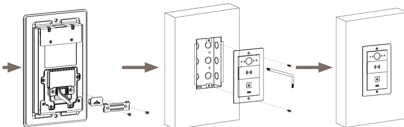
Kies een rubberen plug van geschikte grootte om alle kabels in de cover te duwen. Bevestig de kabelborgplaat aan het achterdeksel met twee schroeven M2,5x6.
