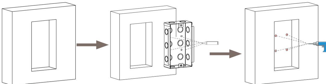
Snijd een rechthoekig gat in de muur met afmetingen 180x101x50. Het gat moet een beetje te groot zijn om alle noodzakelijke kabels in te passen.
