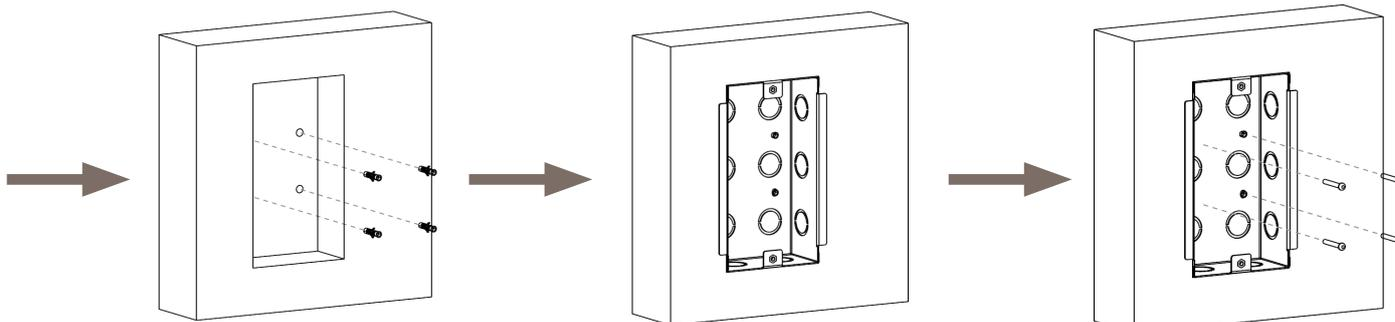
Insérez quatre bouchons dans les trous.
