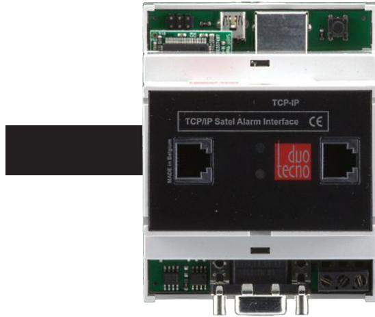
Cette interface peut communiquer avec la centrale d'alarme Integra de Satel. Avec cette interface, on peut armer et désarmer l'alarme via les écrans tactiles Duotecno à condition qu'un clavier de code original de l'alarme soit encore présent.
