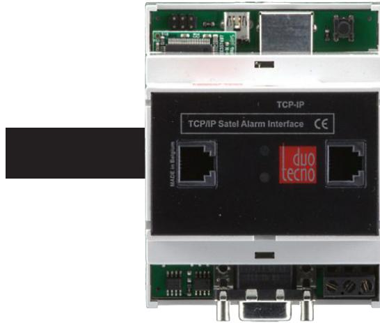
Deze interface kan communiceren met de Integra alarmcentrale van Satel. Met deze interface kan men het alarm bewapenen en uitschakelen via de Touchscreens van Duotecno op voorwaarde dat er nog één origineel codeklavier van het alarm aanwezig is.
