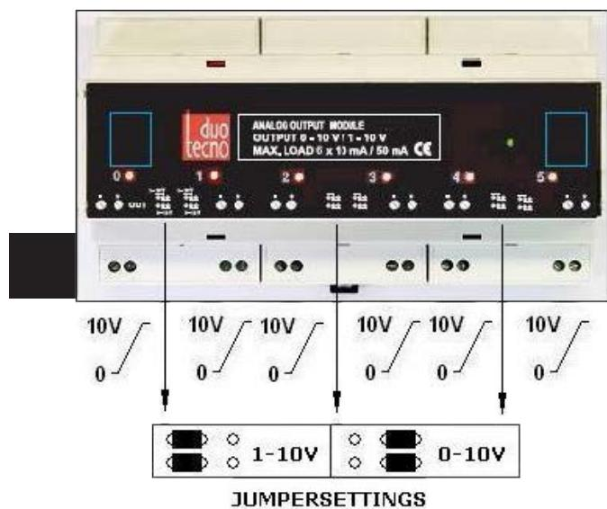
1/10V - 0/10V analoge output module
